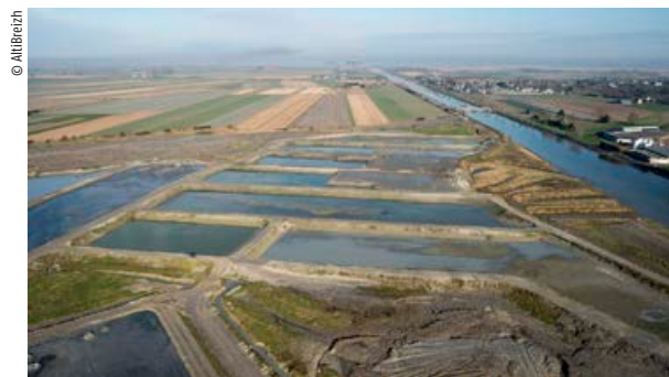
Casiers de décantation de la tangue, partie Nord de l'Anse de Moidrey.
