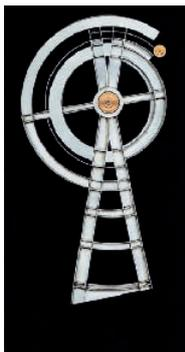
La rotation des vannes permet d'assurer le remplissage par « sur-verse » (par-dessus la vanne) pour limiter les apports de sédiments, et de vidange par une ouverture progressive en « sous-verse » (sous la vanne), ainsi que l'ouverture hydraulique totale, en fonction du jeu des marées et du mouvement des eaux du Couesnon.
